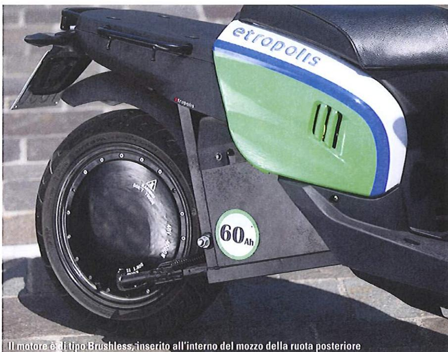
Il motore è di tipo Brushless, inserito all'interno del mozzo della ruota posteriore
